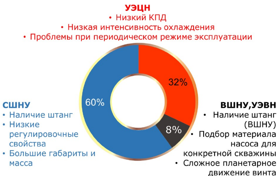
Рис. 1. Распределение малодобитного фонда скважин по способам добычи
